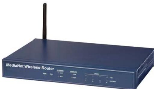
Mit der Basis-Station Web-Control-Modul wireless-Router können drahtlose MediaNet Systemkomponenten an das MediaNet Ethernet-Netzwerk angeschlossen werden.. Die Verwendung des IEEE-Standards 802.11 für lokale Funk-Netzwerke (Wireless LANs) garantiert eine ausge-reifte Technologie und die Kompatibilität zu Geräten anderer Hersteller. Die Bandbreite im Funknetz beträgt 11 Mbit/s. Die Konfiguration erfolgt über einen Standard-WEB-Browser.
