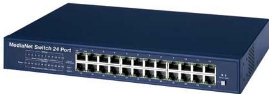
Der 24 Port Switch wird benötigt um die einzelnen Geräte des MediaNet Controlsystems zu vernetzen. Es können auch alle anderen Geräte (z.B. PCs etc.) mit einer Ethernet-Schnittstelle, 10/100 Mbit/s und einem RJ 45 Ausgang angeschlossen werden.
