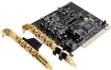
Diese Erweiterungskarte ist ein rein digitaler Audiomixer mit 5 analogen Eingangskanälen, 1 digitalen Eingang, 2 analogen Ausgängen und einen digitalen Ausgangskanal. Alle Ein- und Ausgangskanäle sind stereo und frei zuordbar. Diese Erweiterungskarte ist kombinierbar mit dem Typ e-Unit-Mix-5-2e zu einem Multizonen Mixer für einen teilbaren Raum.
