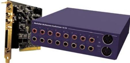
Der 10 Kanal Multizonen-Audiomixer ist ein hochwertiges digitales Mischpult und eine digitale Audio-Kreuzschiene. Mit dieser Erweiterungskarte kann man mehrere teilbare Konferenzräume miteinander verbunden werden und die angeschlossenen Audio-Quellen getrennt geregelt werden. Alle Kanäle können frei zugeordnet werden. Es können bis zu 3 Erweiterungskarten in einer Controlunit betrieben werden.
