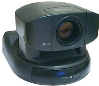
Die hochwertige Netzwerkkamera mit motorischen 12fach Zoom Funktion und motorischer Dreh- und Schwenkbewegung ermöglicht die Live-Videoübertragung in bester Bildqualität über das MediaNet Ethernet-Netzwerk. Die BuildNet WebCam motorisch verwendet neben dem Standard H.323 für Videokonferenzsysteme auch M-JPEG für die Videoübertragung. Integrierter Webserver über TCP/IP und Webbrowser steuerbar und konfigurierbar.
