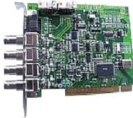
Erweiterungsboard mit 4 FBas-Videoeingängen für den Buildnet VideoControlserver. Zum Anschluss von herkömmlichen Videoüberwachungskameras. Bis zu 4 Erweiterungsboards (16 Video-Kanäle) können in einem BuildNet VideoControlserver betrieben werden.
